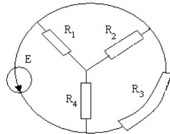
Cunoscand valorile rezistentelor rezistorilor din figura alaturata,  $R_1 = 25 \Omega$  si  $R_4 = 75 \Omega$ , precum si t.e.m.  $E = 18 \text{ V}$ . Sa se afle intensitatile curentilor din fiecare rezistor.
