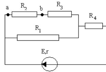
In circuitul din figura alaturata se cunosc:  $R_1 = 10 \Omega$ ;  $R_2 = 20 \Omega$ ;  $R_3 = 30 \Omega$ , intensitatea curentului prin baterie  $I = 1 \text{ A}$  si tensiunea electrica la bornele lui R,  $U_3 = 10 \text{ V}$ . Sa se calculeze valoarea rezistentei  $R_4$ .
