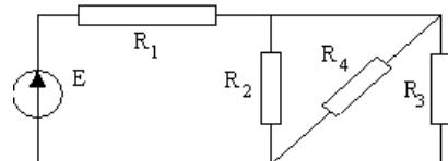
Circuitul din figura alaturata este format din 5 rezistoare identice  $R = 10 \Omega$  si este alimentat de o sursa cu t.e.m.  $E =$  si rezistenta interna  $r = 2 \Omega$ . Sa se calculeze: **a)** Intensitatea curentului principal ( $I_{AB}$ ); **b)** valoarea intensitatii curentului dupa ce bornele AC au fost unite printr-un fir conductor cu rezistenta neglijabila si infuzibila.
