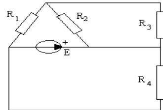
Se da circuitul din figura alaturata in care se cunosc  $E = 6 \text{ V}$ ,  $R_1 = 2 \Omega$ ,  $R_2 = 6 \Omega$ ,  $R_3 = 3 \Omega$  si  $R_4 = 1,5 \Omega$ . Sa se calculeze: **a)** curentul electric ce trece prin baterie; **b)** intensitatea curentului ce trece prin rezistenta  $R_2$ ; **c)** caderea de tensiune pe rezistorul  $R_4$ .
