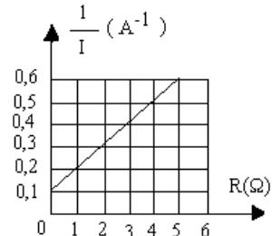
Labornel unei baterii este legat un rezistor cu rezistența  $R$ , variabilă. Dependenta inversului intensitatii curentului electric  $1/I (\text{A}^{-1})$  ce strabate rezistorul, de rezistența electrică a rezistorului este ilustrată în figura alaturată. Folosind datele din figura alaturata, tensiunea electromotoare a bateriei  $E$  si rezistența sa internă  $r$  au valorile:
